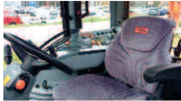
Der Fahrersitz kann um 180° gedreht werden.
